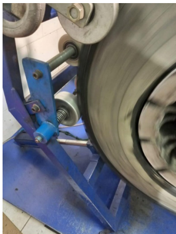
10. Presión de rodillos para sacar el aire entre la banda de rodamiento y el piso del casco.
