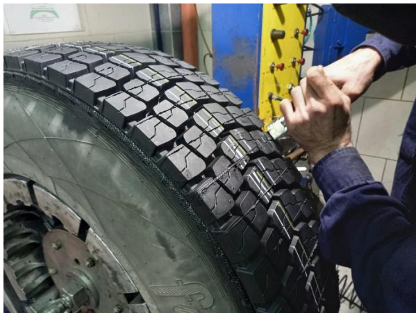
9. Corte de la banda de rodamiento; se le pega una goma o hule cojín de unión, para facilitar la adhesión de la banda a la carcasa. Engrampado.
