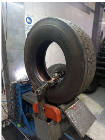
4. Los neumáticos que continúan el proceso son parchados internamente.
