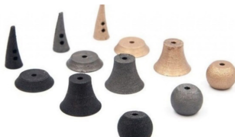
Piezas impresas 3D a partir de filamentos de caucho de NFU
