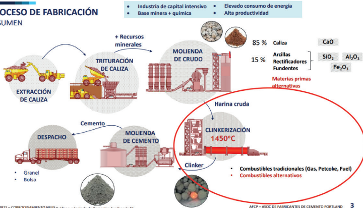
Figura A1F2 Proceso de fabricación de cemento
