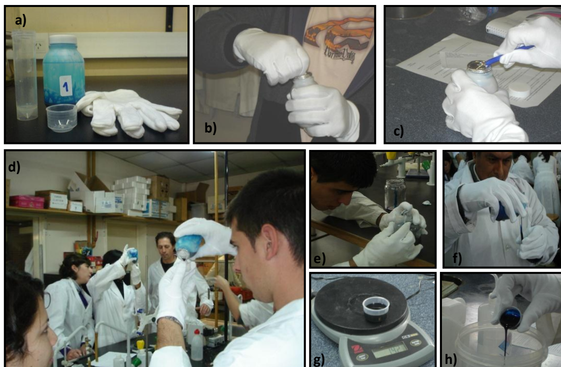
a) Ejemplo de un kit de trabajo para formulaciones líquidas. b) y c) Ruptura del sello del aluminio. d), e) y f) Dosificación con distintos instrumentos. g) y h) Pesaje y volcado de una formulación líquida.
