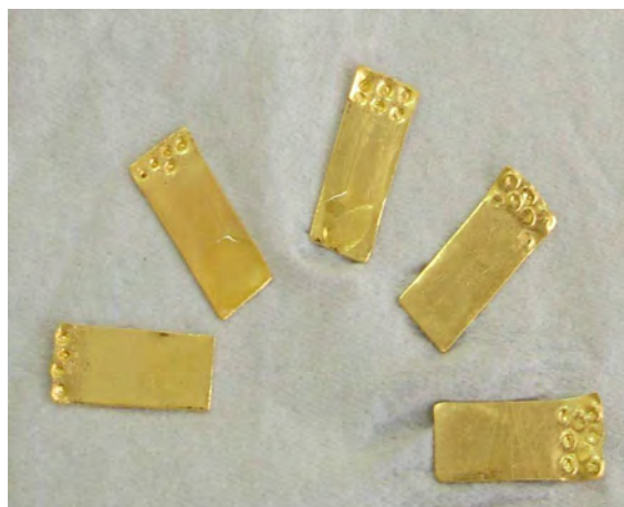
Figura 2.22 Láminas de Au macizo empleadas como electrodos de trabajo
