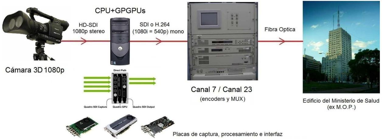
Figura 3.23: Captura, super-compresión, codificación, multiplexado y transmisión.
