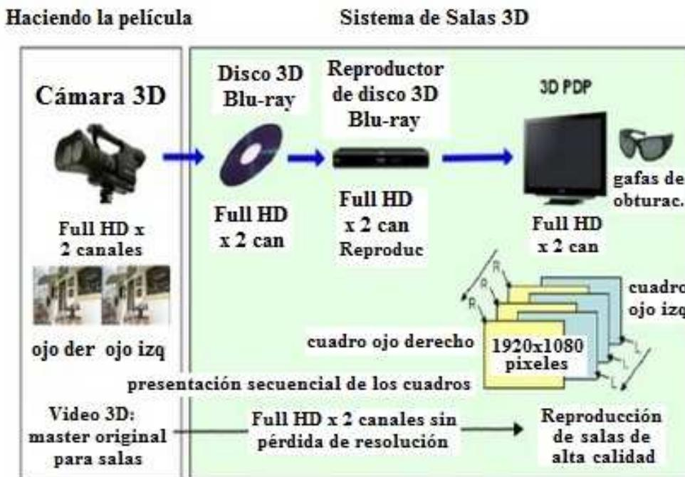
Fig.H.13: Masterización para cine digital 3D de alta definición.
