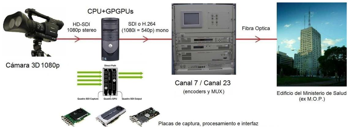
Figura H.1: Diagrama de captura, procesamiento y transmisión.
