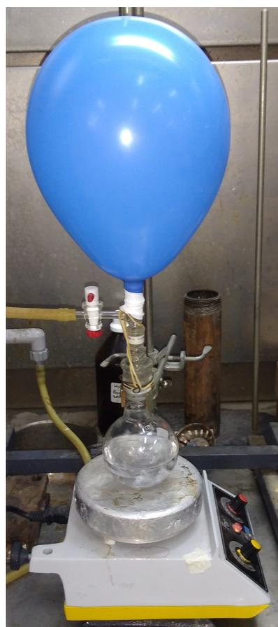
(b) Foto del dispositivo para hidrogenación en batch.
