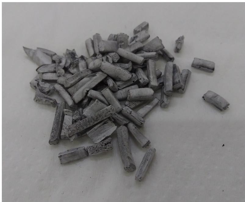
Figura 3.6: Recortes de Plástico 1 (4 % Pd/C\*) sin mezcla BD:AV.
