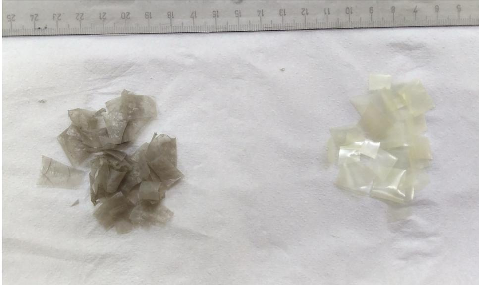
(a) Recortes de PE solarizado (izquierda) y virgen (derecha)
