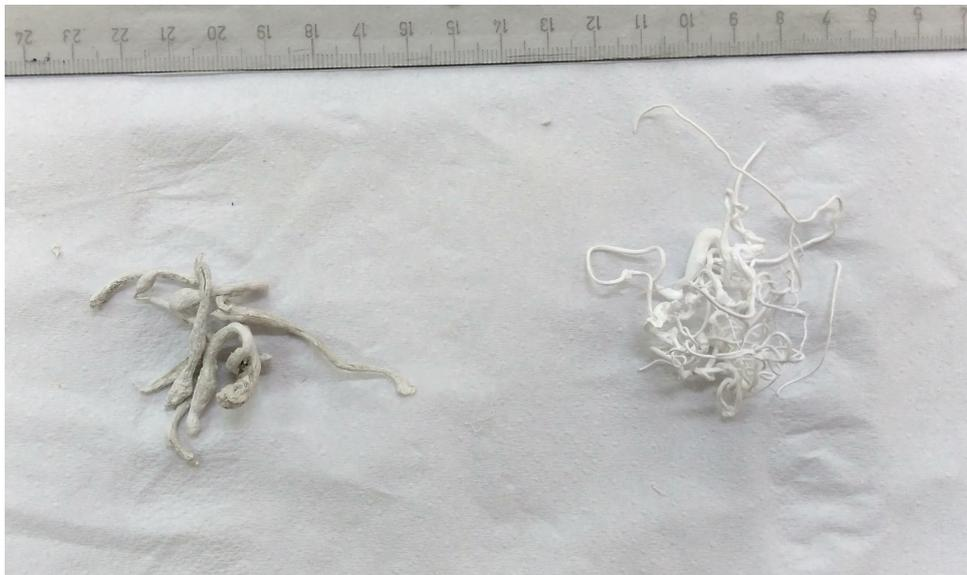
(b) Hilos de PE solarizado (izquierda) y virgen (derecha).
